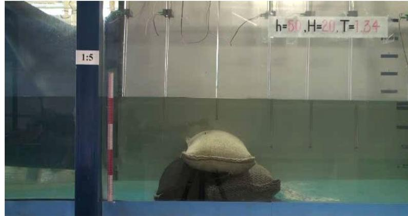
Modelado de laboratorio de mitigación de energía undimotriz por espigones sumergidos
